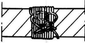
Вязка узкого биндажа шириной от 5 до 10 мм
